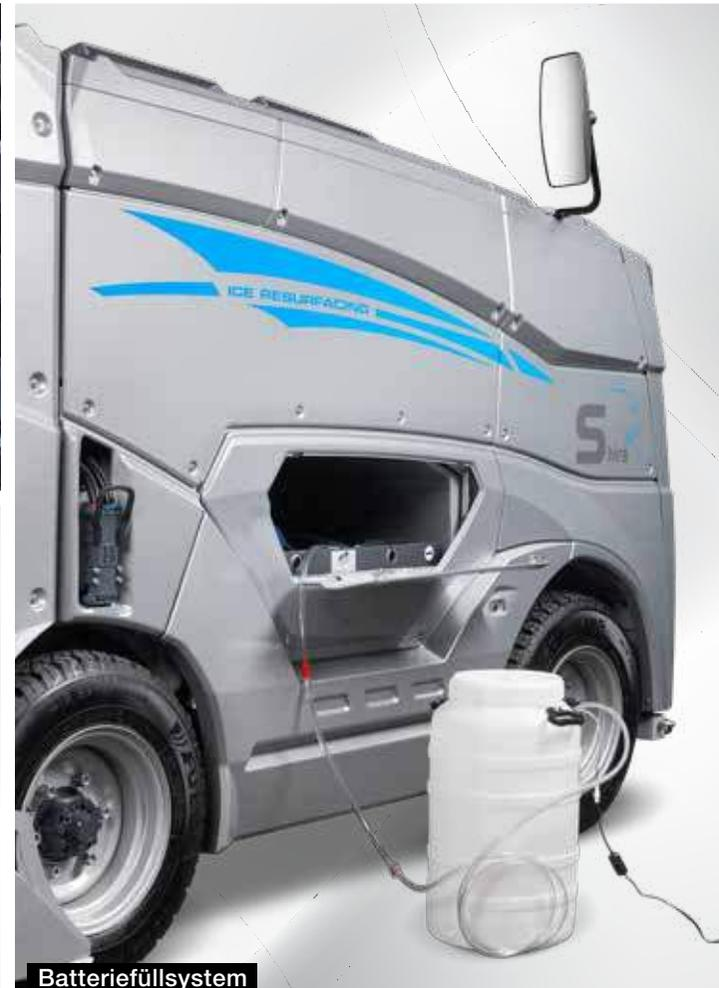
Die robuste, geschlossene Blei-Säure-Panzerplattenbatterie und das langlebige Ladesystem der Firma Fronius, eine Kombi von höchster Qualität. Das Ladesystem ist hochintelligent, erkennt Alter und Ladezustand der Batterie automatisch und lädt sehr schnell sowie energiesparend. Batteriewasser wird rasch über das zentralisierte Befüllungssystem in die Batterie gepumpt.
